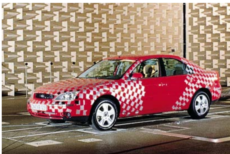
Fahrzeug auf dem Rollenprüfstand im reflektionsarmen Raum bei Ford.
