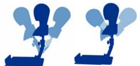
Der HSM IV lässt sich neigen, drehen und in unterschiedlichen Höhen ausrichten.
