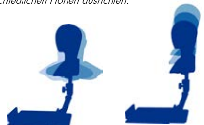
Der HSM IV lässt sich neigen, drehen und in unterschiedlichen Höhen ausrichten.
