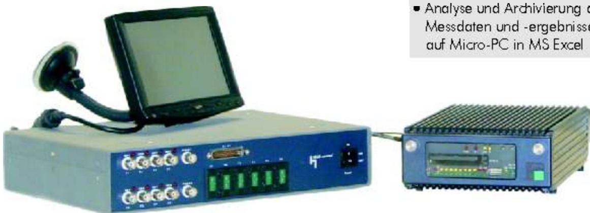
Bild 13: Die Hardware besteht aus einem Frontend, einem Micro-PC und einem Minidisplay mit Touchscreen.
