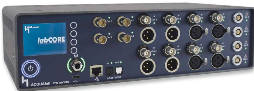
*labCORE* ist das modulare Mehrkanal-Frontend für präzise und effiziente Messungen im Bereich Sprach- und Audioqualität
