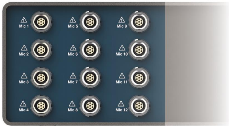
labCOREの背面パネル、coreIN-Mic4ボードを3つ搭載した例
