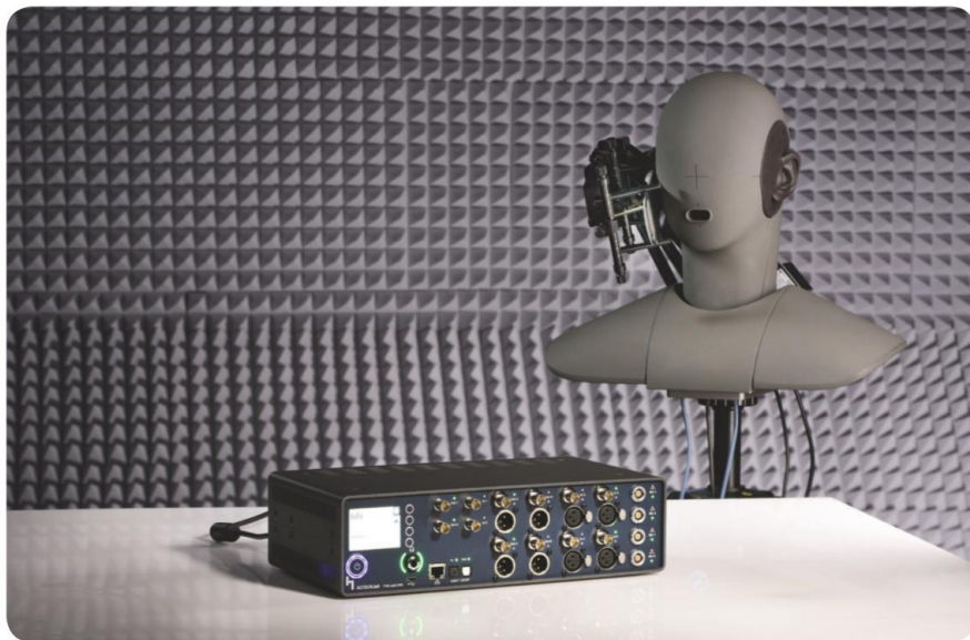
HMS II.3, HHP IV, labCOREで構成するVoIP測定環境
